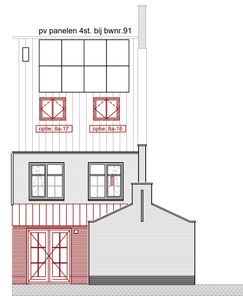
Achtergevel schaal 1:100 bouwnummers: 83 en 91 optie 8a-01 = uitbouw 1,2m1 optie 8a-16 = dakraam achtergevel positie a optie 8a-17 = dakraam achtergevel positie b
