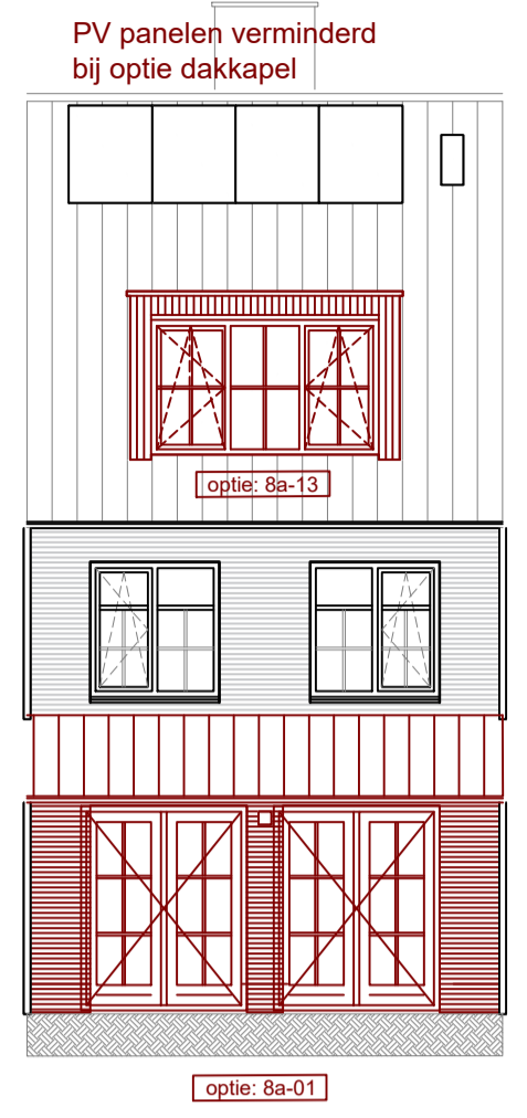
Achtergevel schaal 1:00 bouwnummer: get. 85 en 92 gesp. 84 optie 8a-01 = uitbouw 1,2m1 optie 8a-13 = dakkapel achtergevel
