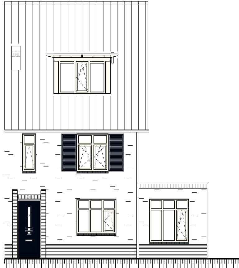
type P1/P5 optie garage bij woonkamer i.c.m. uitbouw optie dakkapel klein voor
