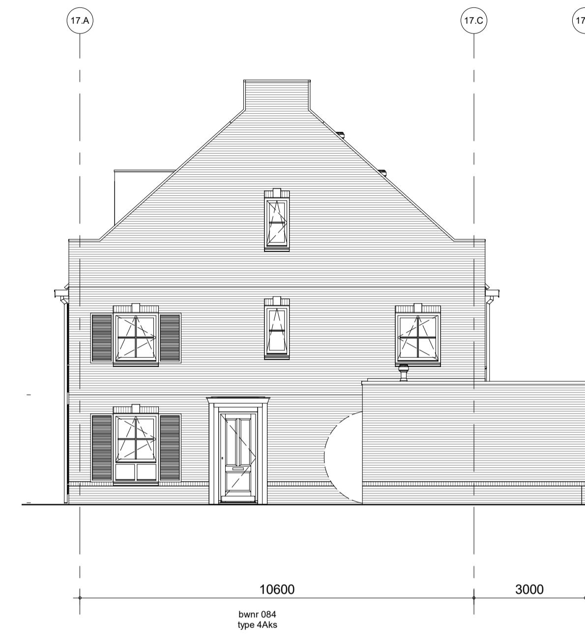
zijgevel rechts - blok 17
