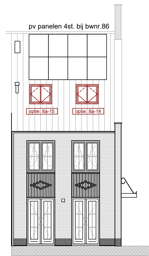
Voorgevel schaal 1:100 bouwnummer: 86 en 93 optie 8a-14 = dakraam voorgevel positie a optie 8a-15 = dakraam voorgevel positie b
