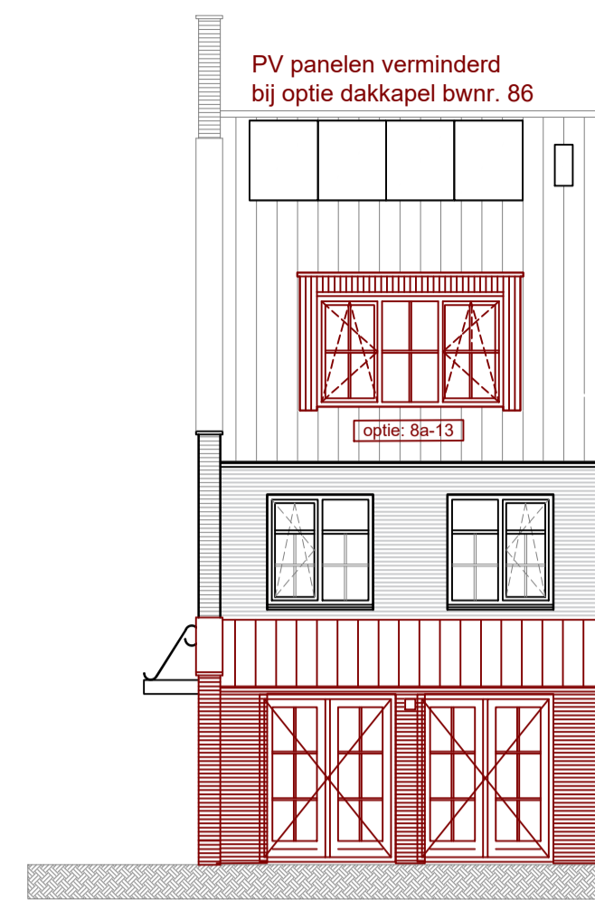
Achtergevel schaal 1:100 bouwnummer: 86 en 93 optie 8a-01 = uitbouw 1,2m1 optie 8a-13 = dakkapel achtergevel
